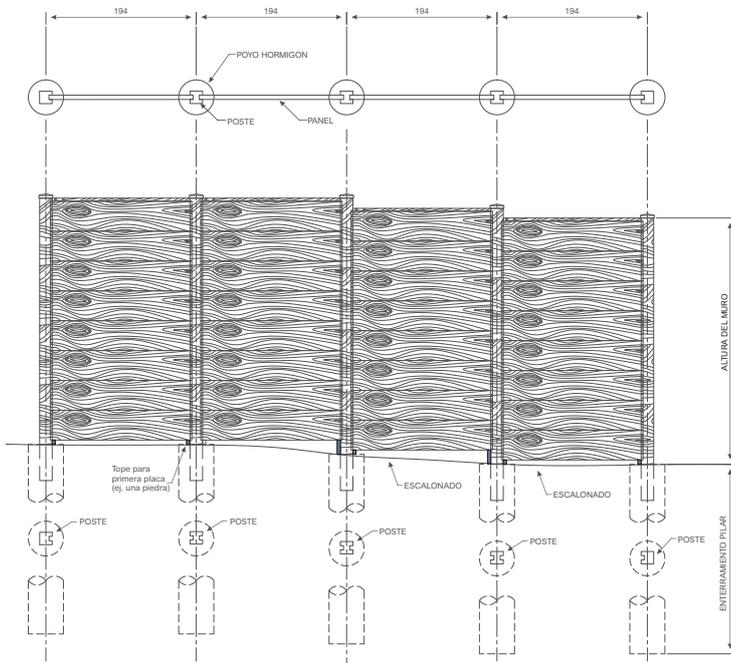
ELEVACION - DEL MURO Y PILAR
